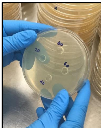
Figura 7. Técnica de Kirby-Bauer de difusión en agar con pozos perforados. Pozos marcados como 20, 40, 60 80 ug/ml.
