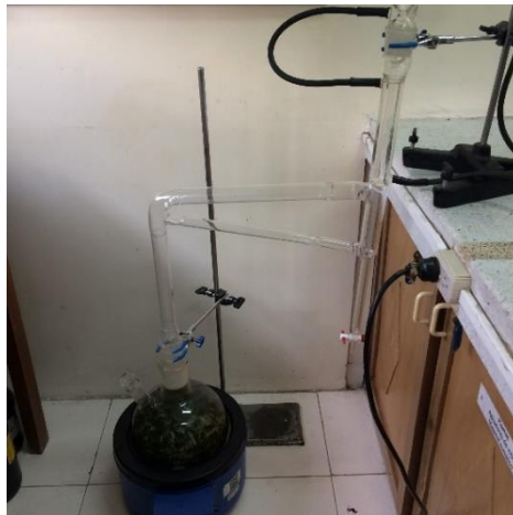
Figura 4. Hidrodestilación Clevenger modificado
