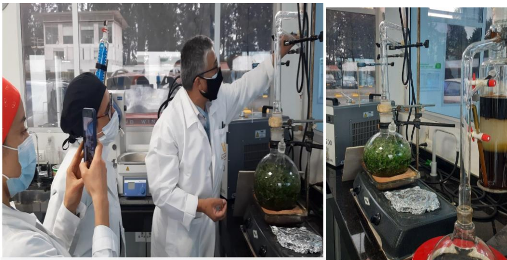
Fig 18. Hidrodestilación (obtención del aceite esencial).
