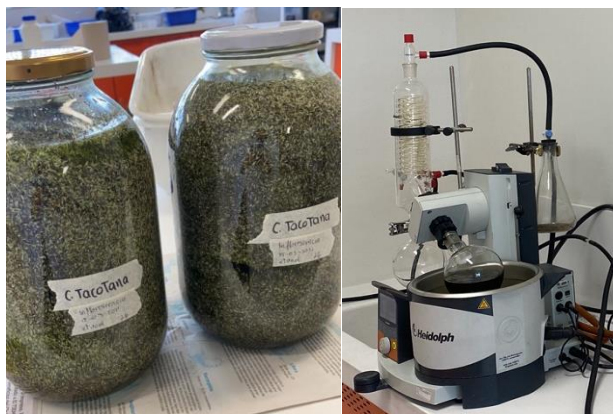
Figura 3. Extracción por maceración con etanol 96% de cada parte de la planta.
